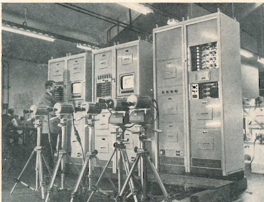
Alla centrale termonucleare di Trawsfynydd, nel Galles, sta per essere installato uno dei più grandi sistemi di televisione a circuito chiuso europei. Ben 58 telecamere comandate a distanza saranno impiegate per le operazioni di controllo e verifica del funzionamento della pila atomica. Il complesso è stato costruito dal gruppo PYE LTD di Cambridge (Inghilterra).
